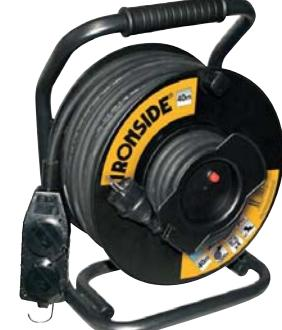
40m. 3x2,5mm<sup>2</sup>. 16A-230V. Potència màxima enrotllat: 1200W. Potència màxima totalment desenrotllat: 3600W.
